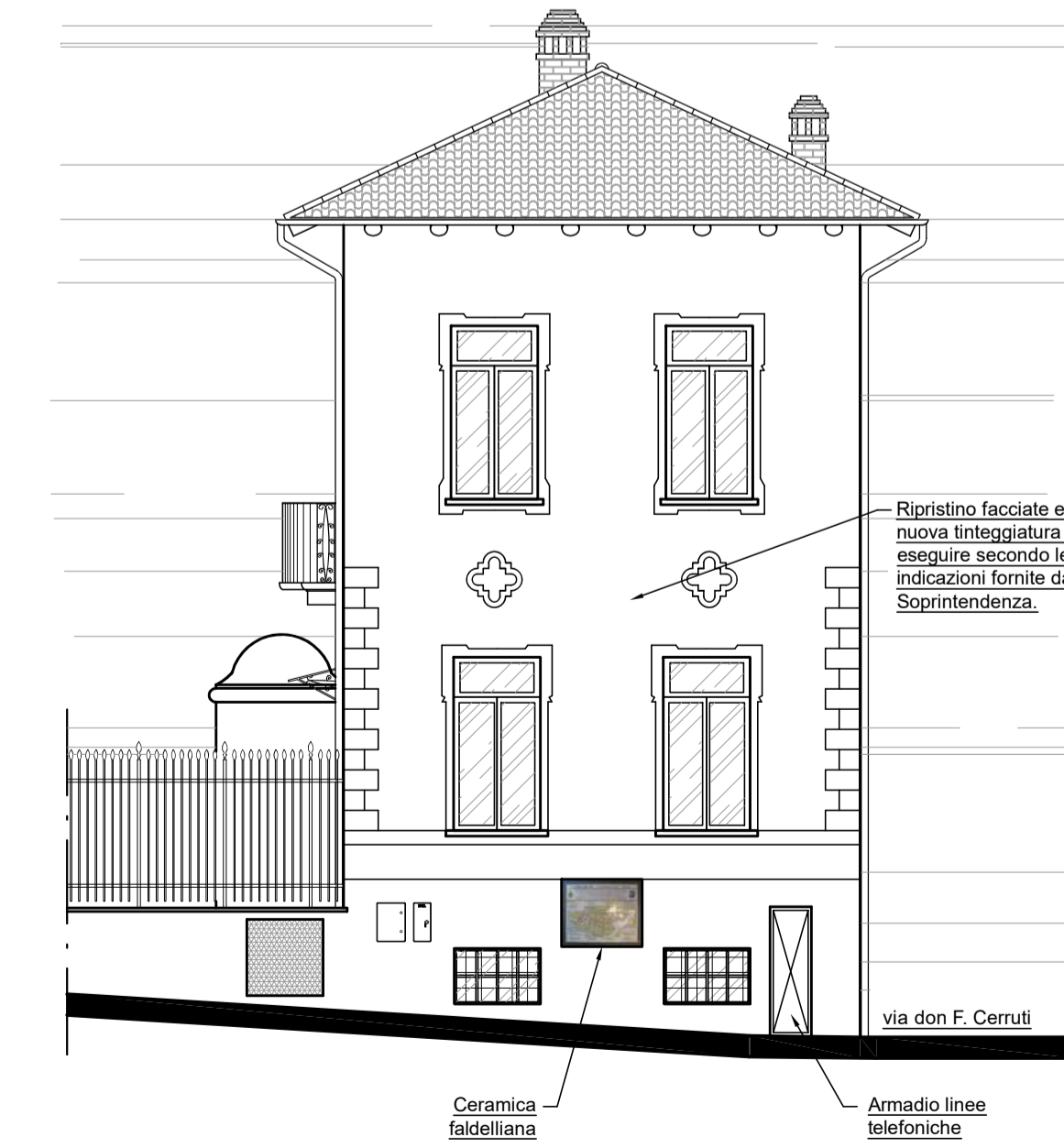
Prospetto lato p.zza del Municipio Sc. 1/100
