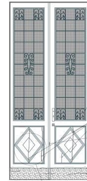
Fenomeni di degrado generalizzato del serramento dovuto all'esposizione agli eventi atmosferici, all'invecchiamento naturale, a depositi superficiali, scropolature e scheggiature, parziali rotture dovute alla mancata manutenzione.
