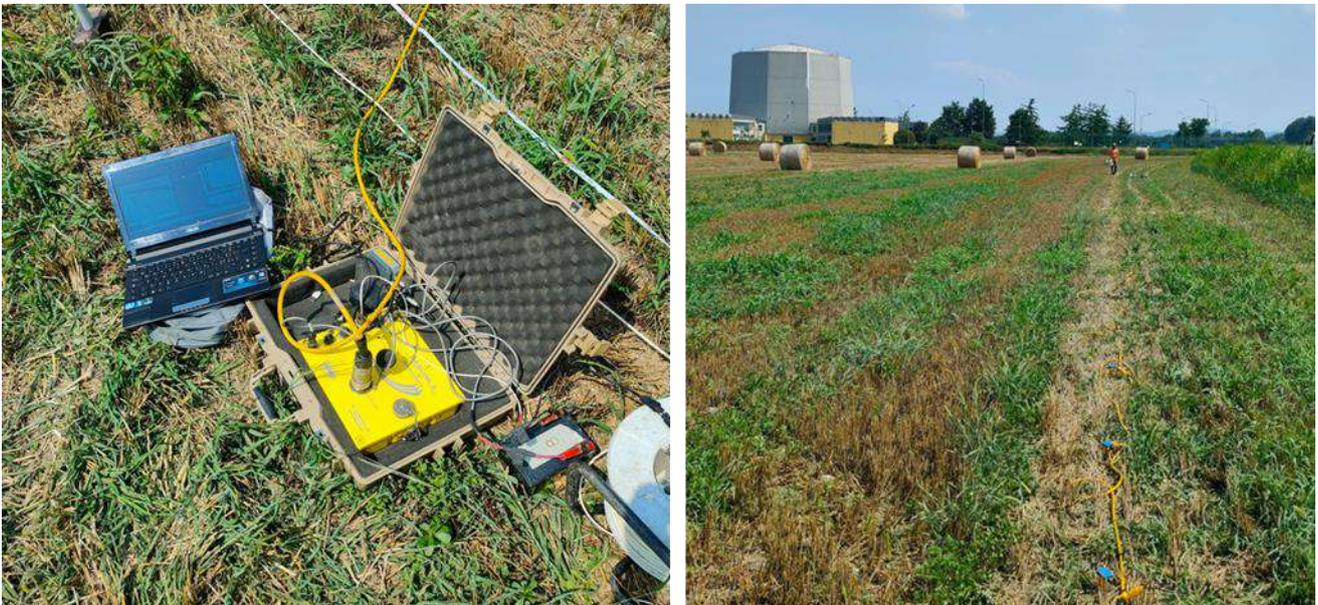
*Figura 3 – Sismografo DAQLink IV (Seismic Source, USA)*
