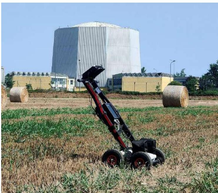
Figura 5 – Strumentazione georadar IDS RIS Hi-Mod (IDS, Italia)
