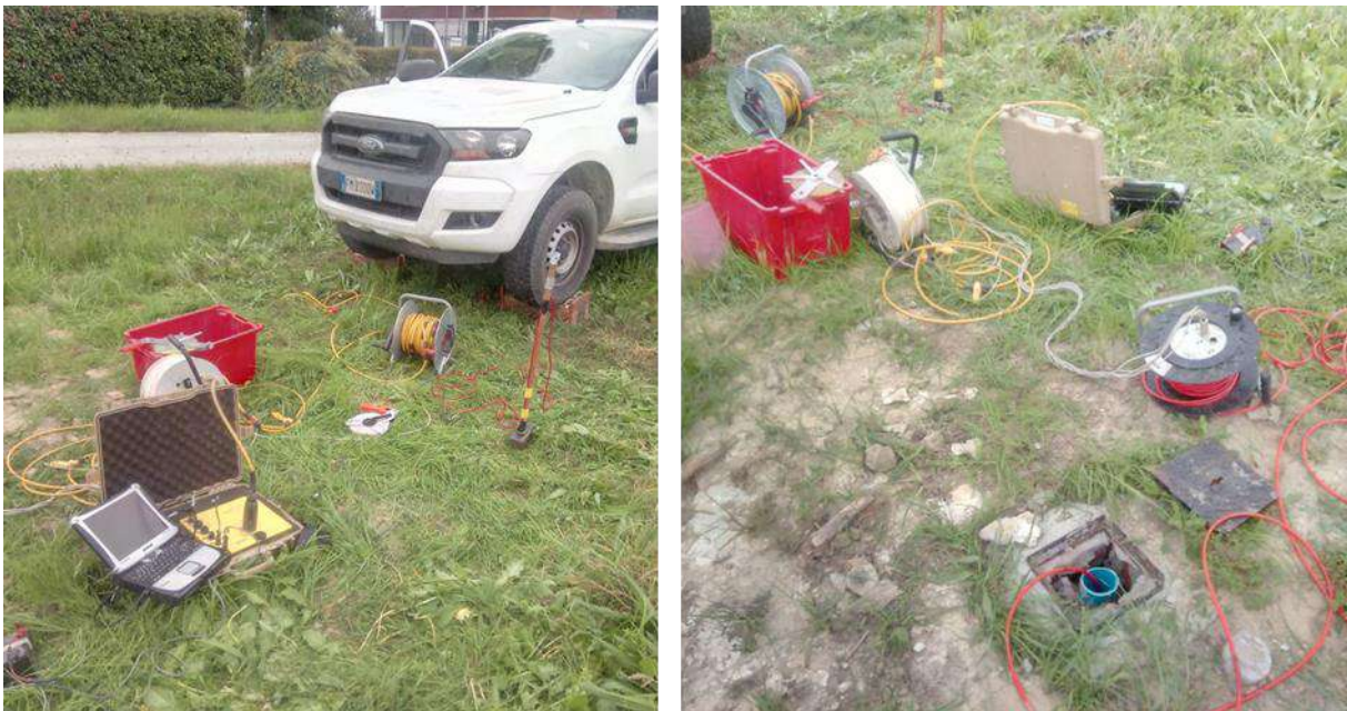
Figura 4 – Strumentazione per indagini down-hole durante la fase operativa
