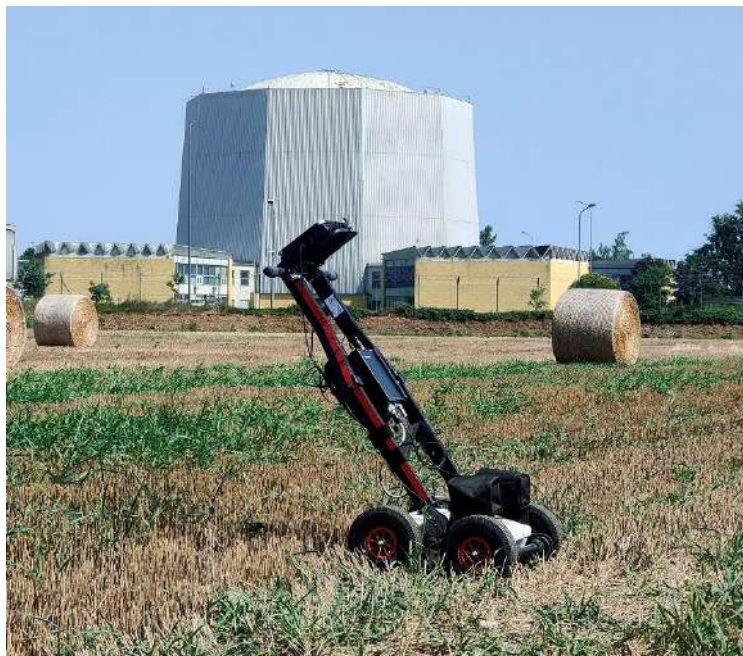
Figura 5 – Strumentazione georadar IDS RIS Hi-Mod (IDS, Italia)
