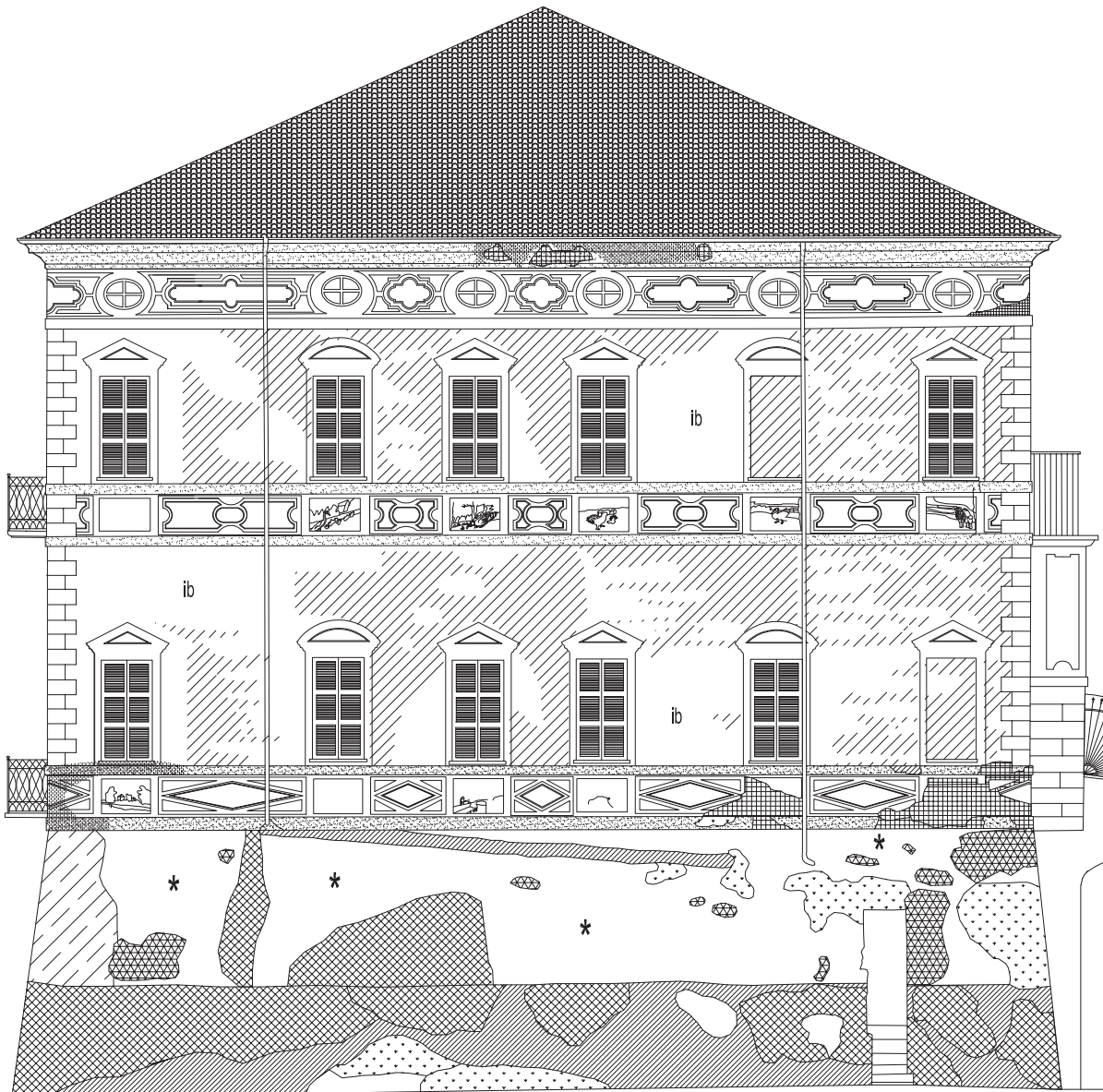
Prospetto Sud Mappatura del degrado - principali interventi di restauro Scala 1:50
